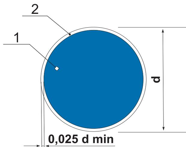
$d$  – диаметр круга; 1 – основная поверхность; 2 – кант
