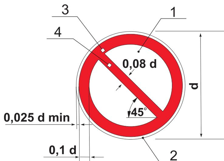
$d$  – диаметр круга; 1 – основная поверхность; 2 – кант; 3 – кайма; 4 – поперечная полоса
