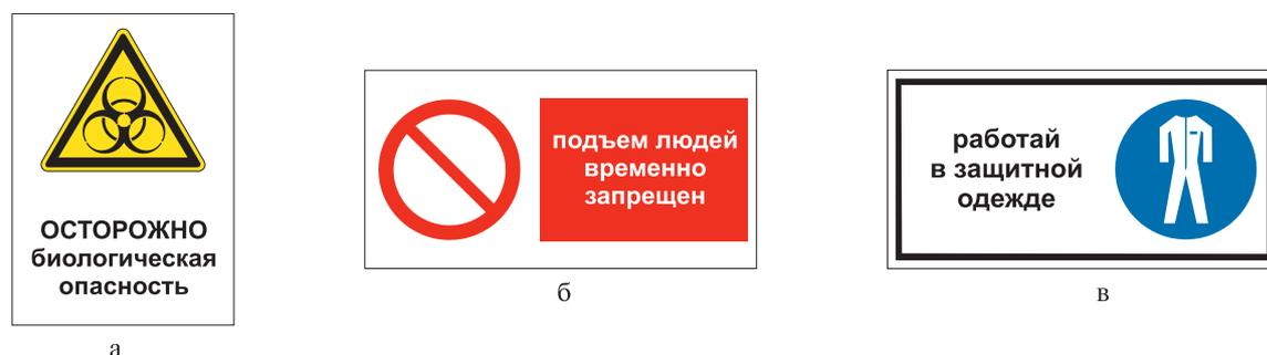
а – текст расположен ниже знака безопасности; б – текст расположен справа от знака безопасности; в – текст расположен слева от знака безопасности
